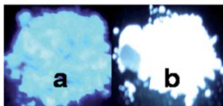
Luminescence de LaNbO_4 (a) et La_{0,96}Dy_{0,04}NbO_4 (b) sous excitation UV.
